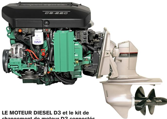
**LE MOTEUR DIESEL D3 et le kit de changement de moteur D3 connectés aux anciennes embases AQ290.**
